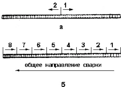
Рис. 4 Порядок наложения длинных швов
